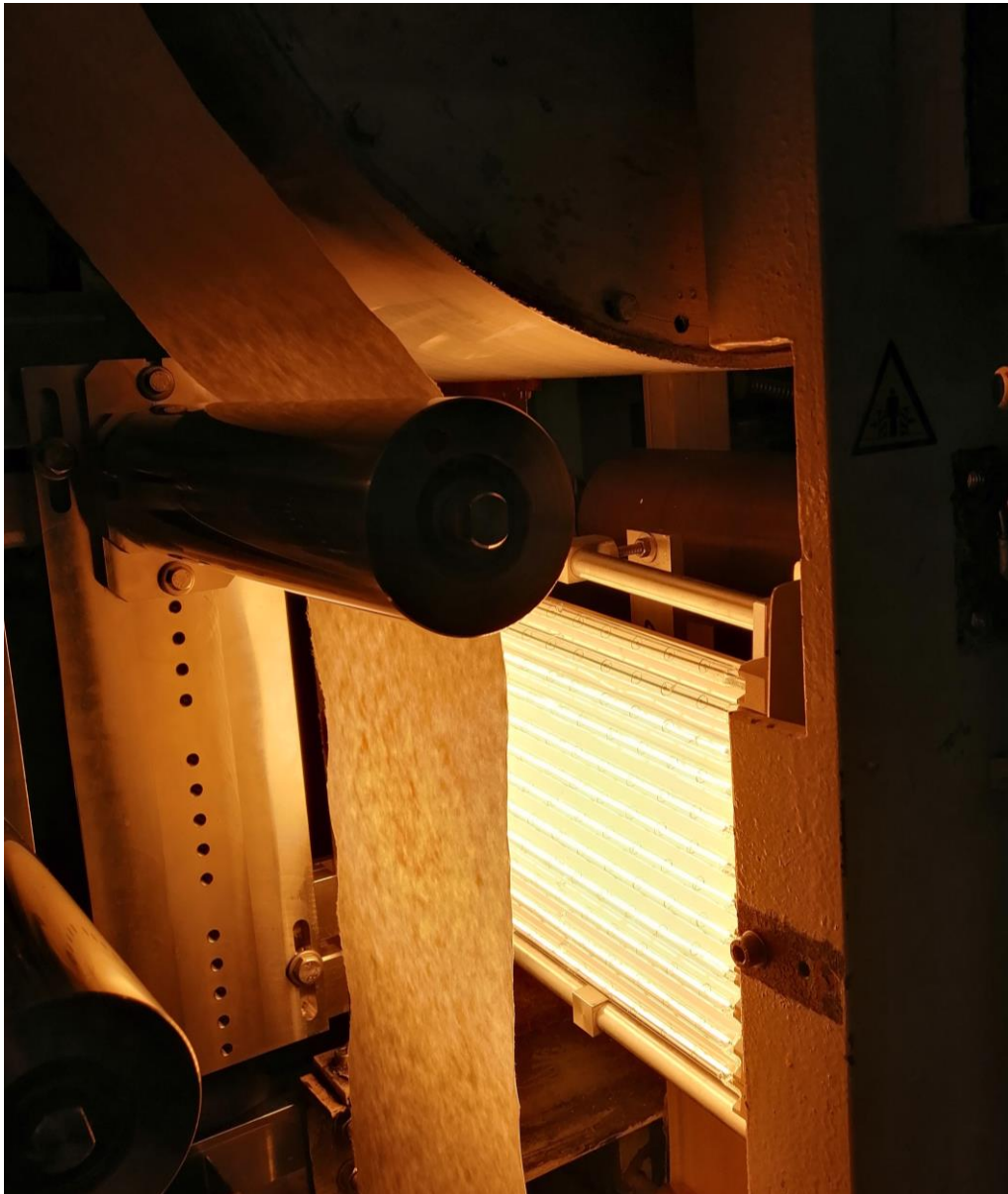
Abbildung 17: Halogentrocknung aus Eigenfertigung zur Trocknung von Papier und ACC
