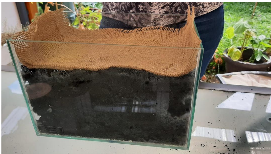
Abbildung 70: Kompostiersversuch fertig angesetzt
