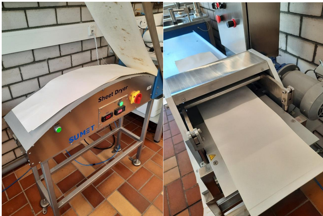
Abbildung 13: Pressen in der SUMET-Pressen und Einlegen in den SUMET-Trockner
