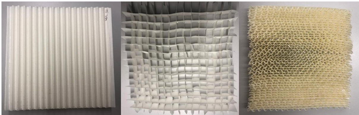
Abbildung 50: Kerngeometrien zur Herstellung von Sandwichstrukturen (von links nach rechts: Welle, Kreuzsteg und Wellsteg)
