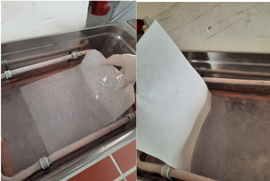
Abbildung 10: Blatt wird von links eingetaucht, durch die Lösung gezogen und auf der rechten Seite herausgezogen
