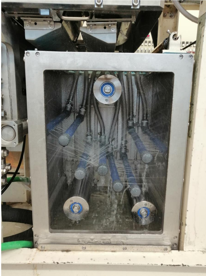
Abbildung 16: Waschstufe zur Neutralisation des Lösungsmittels
