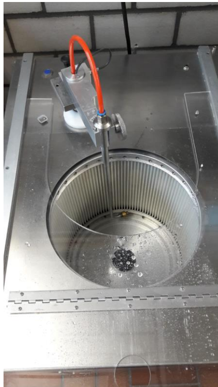
Abbildung 4: SUMET-Dynamischer Blattbildner, Draufsicht auf Trommel, Düse heruntergefahren
