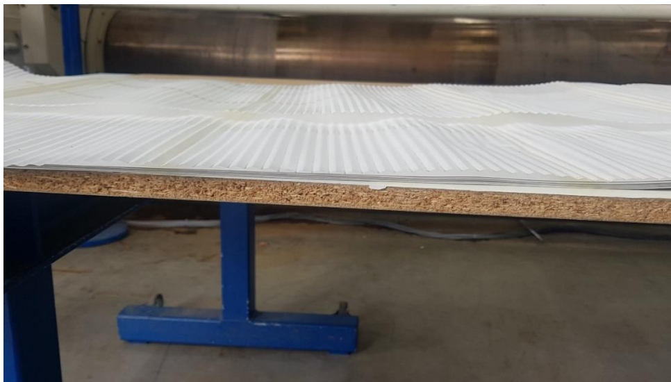
Abbildung 44: Kalt geformte Welle aus ACC (70g/m 2 NBSK/Euka 70/30)
