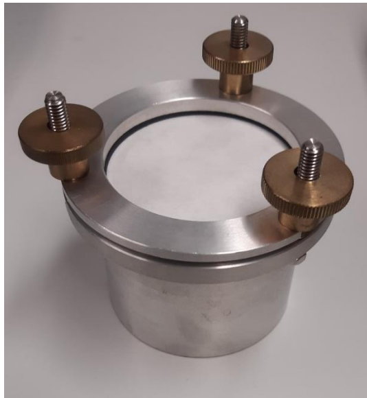
Abbildung 58: Prüfaufbau mit Evaporationskammer für den Hexan-Test nach BASF
