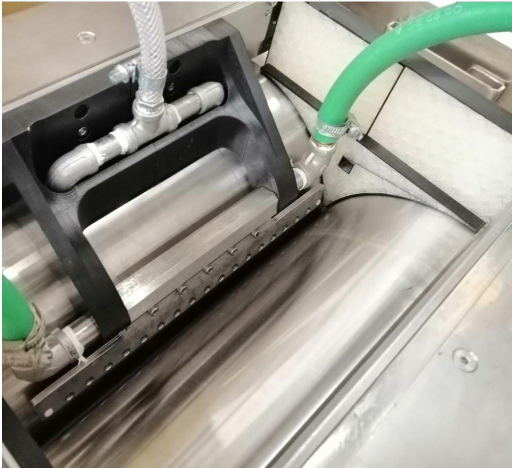
Abbildung 15: Umgebaute Leimpresse für die ACC- Herstellung, inklusive eines Wärmetauschers und einer Zuführung des Lösungsmittels
