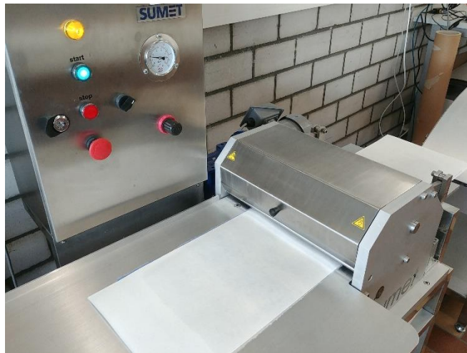
Abbildung 5: SUMET-Pressen mit gerade durchlaufendem Blatt zwischen Gautschkartons
