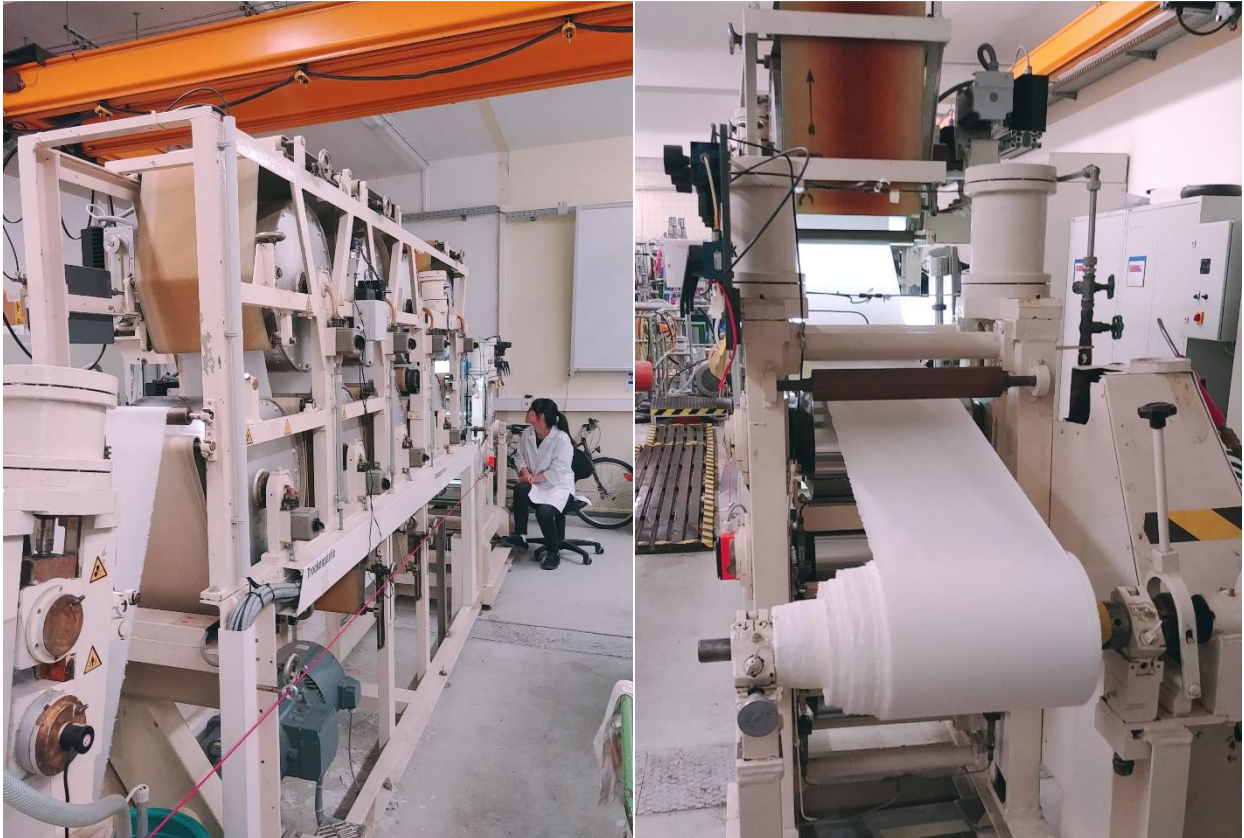
Abbildung 8: Trockenpartie mit Trockenzylindern sowie Glättwerk und Aufwicklung der Pilot-Papiermaschine
