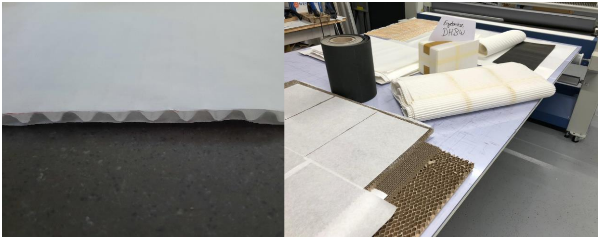
Abbildung 46: Klebearbeiten bei Mainteam: Verkleben von Wellstegplatten und Wabenplatten (rechts) und die fertige Wellpappe (links).
