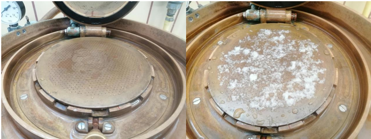
Abbildung 67: Rückstand von Papier (links) und ACC (rechts) nach der Fraktionierung mit einer Lochplatte mit dem Lochdurchmesser 0,7 mm
