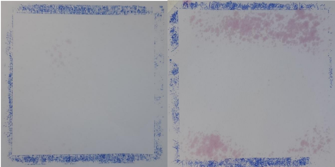
Abbildung 55: Fettbarriere ACC Stufe 2 (links) und 3 (rechts) nach DIN 53116
